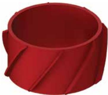
Центраторы-турбулизаторы ЦТЖС предназначены для оснащения обсадных колонн из труб по ГОСТ 632 с целью центрирования колонны в скважине, закручивания вокруг оси скважины и турбулизации потока жидкости в затрубном пространстве при спуске и цементировании обсадных колонн.
